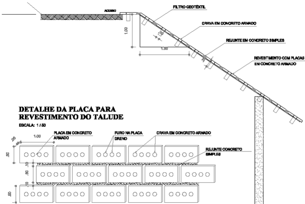
Figura VI.15 - Detalhe da placa de concreto poroso de revestimento para lagoa de infiltração.
