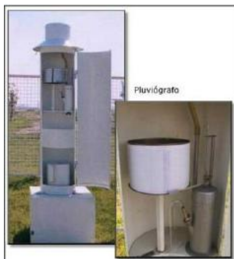
Figura IV.2- Pluviógrafo analógico de bóia.
