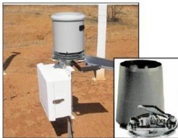
Figura IV.3- Pluviógrafo digital de cubas basculantes
